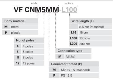
Stock items VF CNP4MM VF CNP4PM VF CNP5MM VF CNP5PM VF CNP8MM VF CNM4MM VF CNM4PM VF CNM5MM VF CNM5PM VF CNM8MM VF CNM8PM VF CNM12MM-L16
